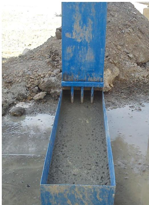
شکل 3- آزمایش جعبه L
