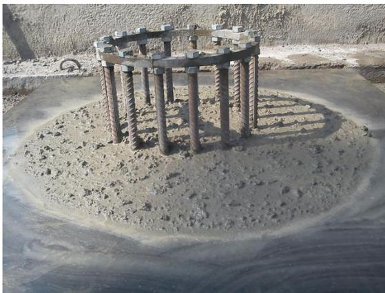
شکل 2 - آزمایش حلقه J.
